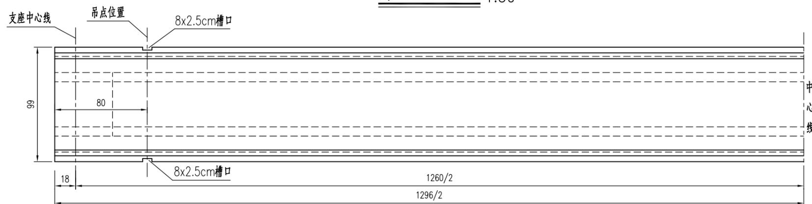
铰缝钢筋施工大样
