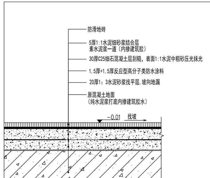
1:3水泥砂浆垫层向地漏找坡 i=1% (卫生间内)
