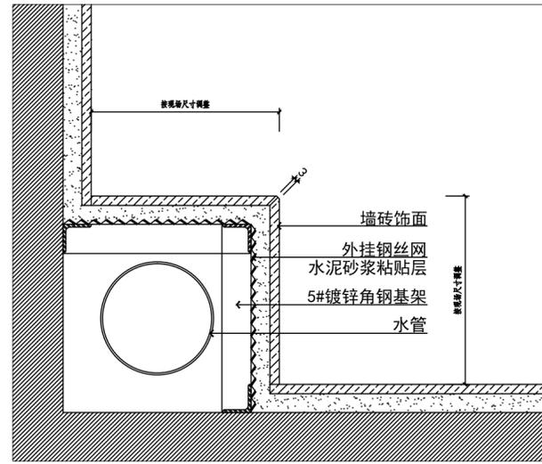
墙砖封包立管剖面图
