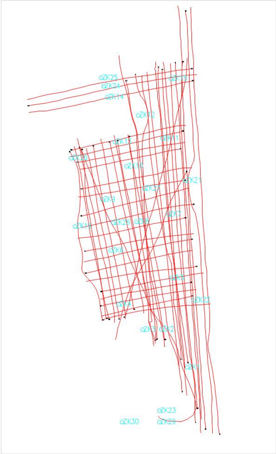
图 3.2-1 物探工作测线和验证钻孔布置平面图
