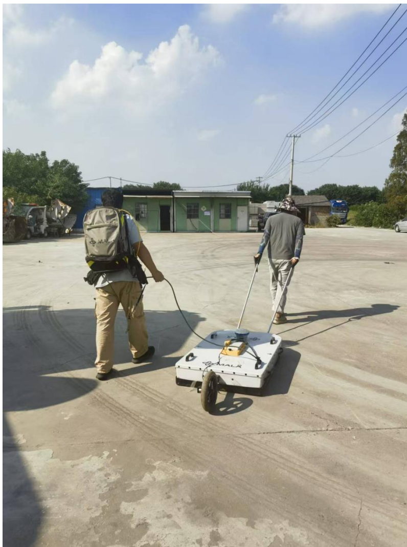
图 3.2-2 现场探地雷达过程照片
