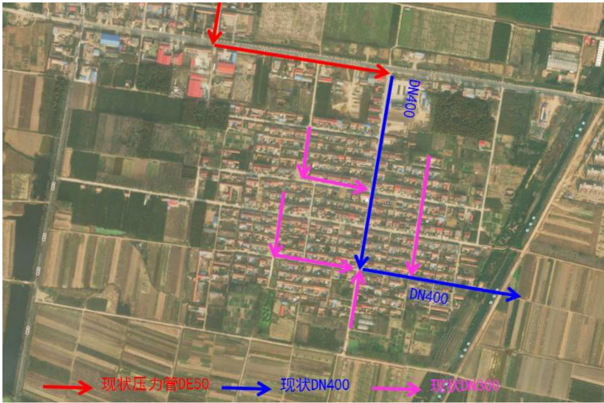
图 1-1 现状污水管线走向图
