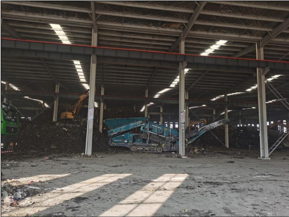
图 5.4-1 现场筛分设备及场景照片（类似项目示意图）
