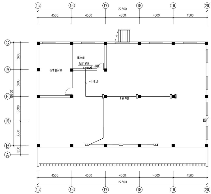
架空层疏散指示平面图 1:100
