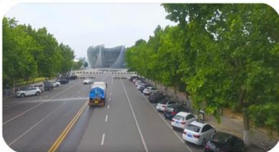
作业中的高压冲洗车
