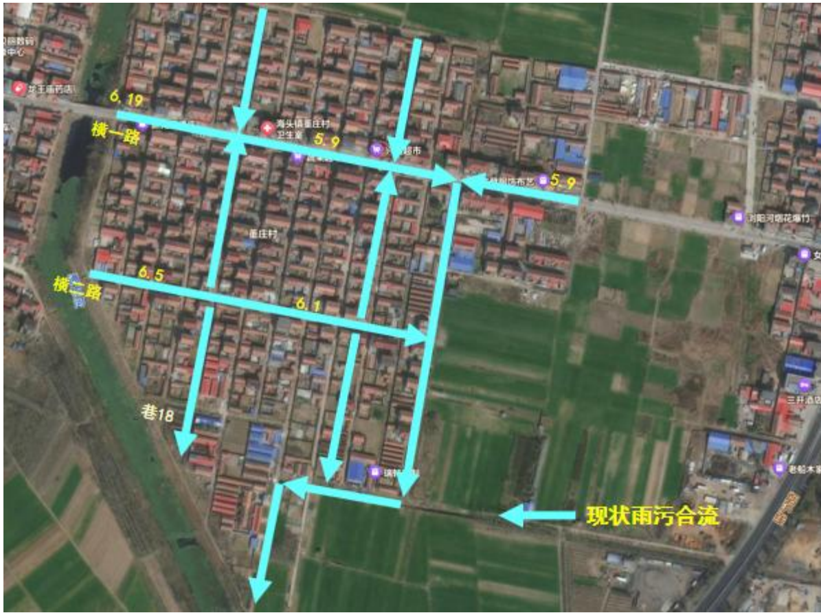
图 1-1 现状雨污合流管线走向图
