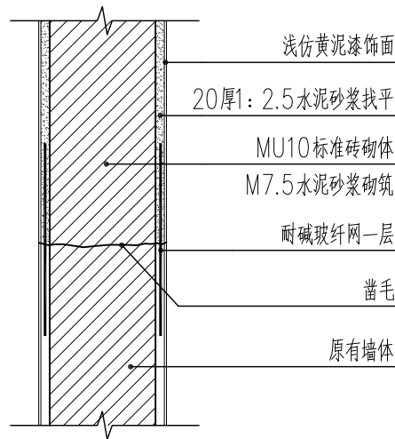
2 新砌墙体做法详图 SCALE 1:15
