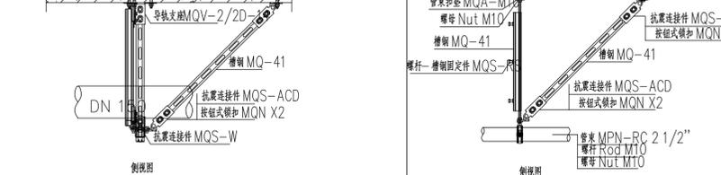
07. 给水排水管道四向抗震支吊架大样图
