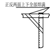
垂直接地体与水平接地体的连接
