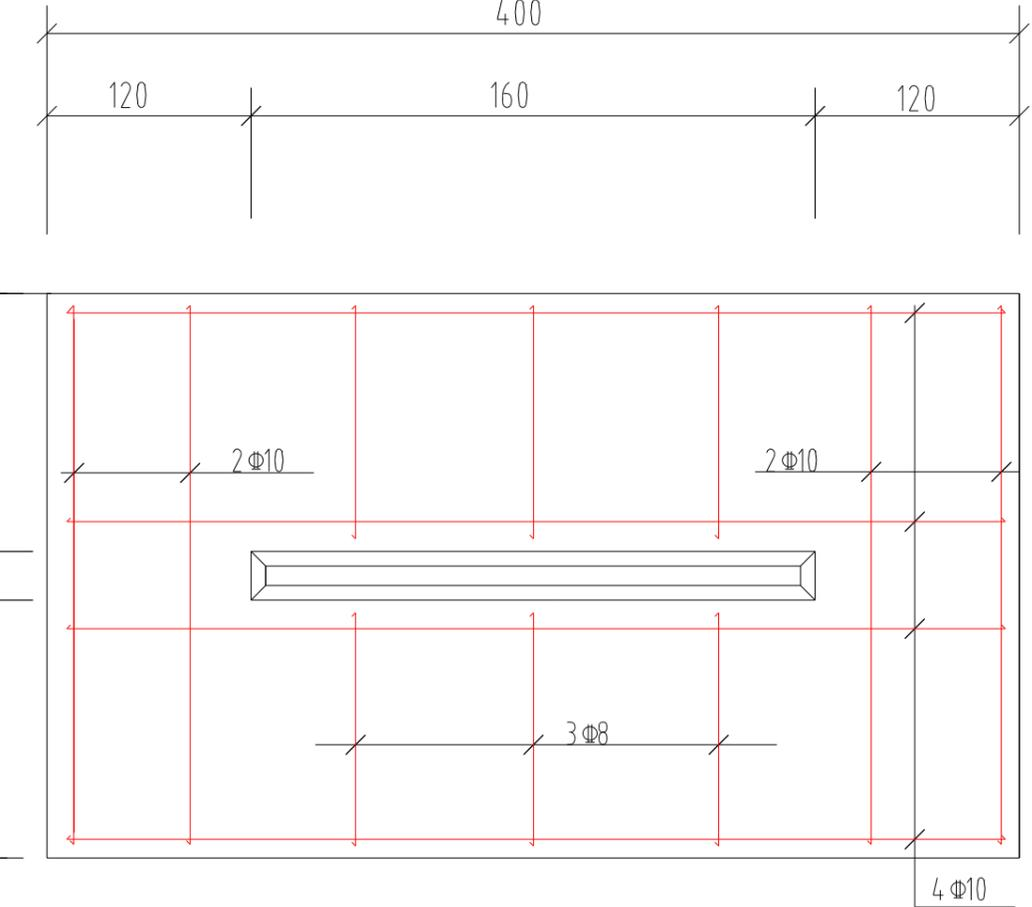
预制混凝土盖板配筋
