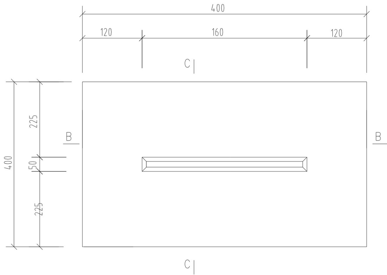
预制混凝土盖板平面大样
