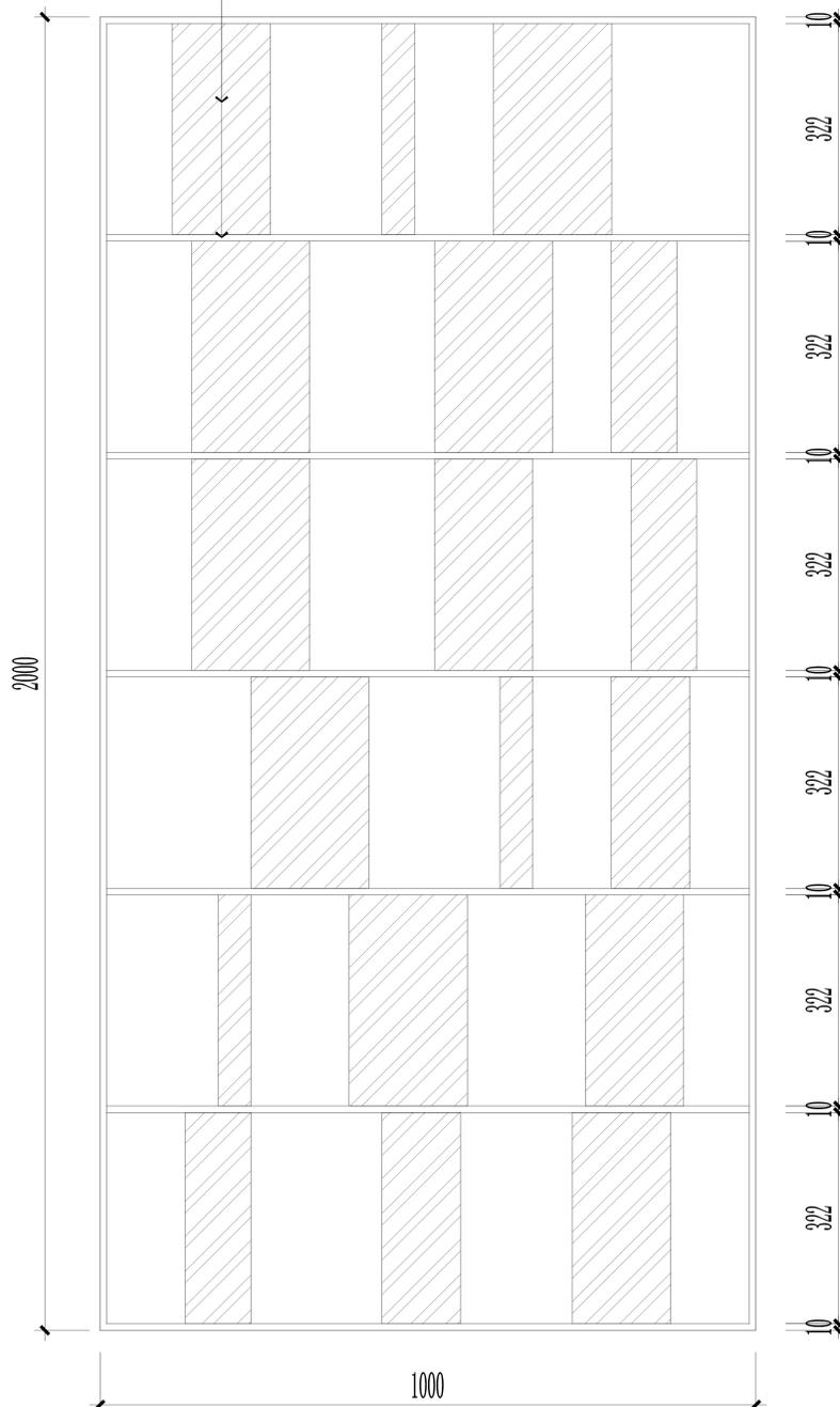
02 ELEVATION 入口处隔断架大样 SCALE 1:8
