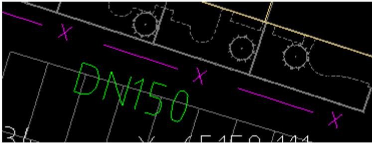
回复：此管为室内消火栓室外管网，材质为钢丝网骨架。
