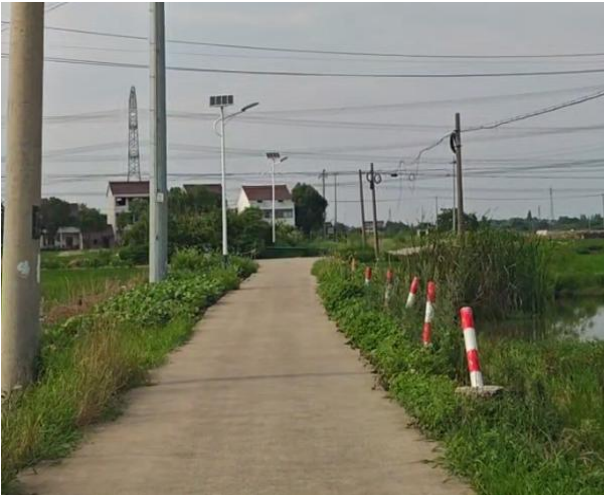
图 4-4 警示柱损坏且颜色不符合规范要求
