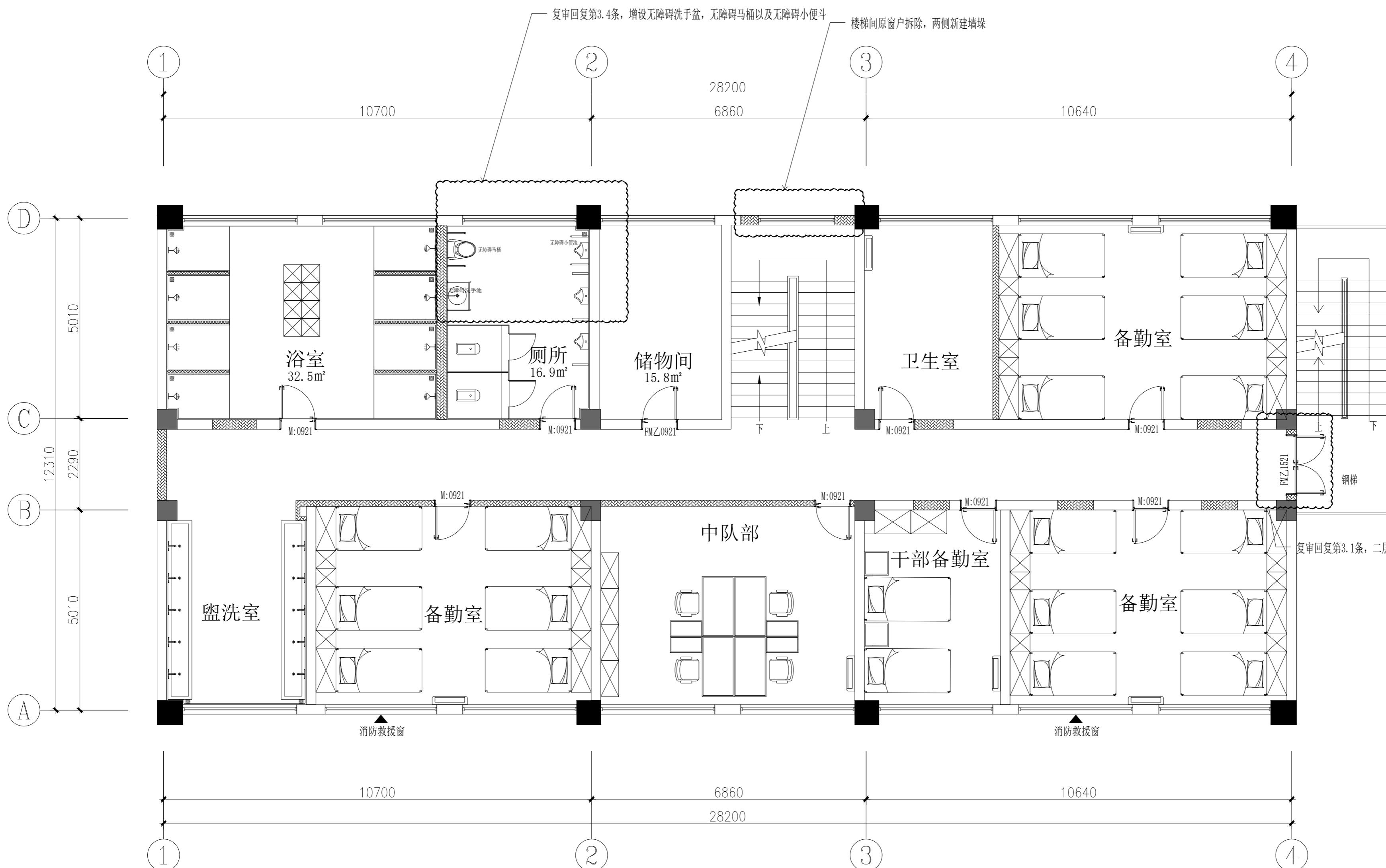
注: 备勤室等房间开向公共走廊或封闭式外走廊的疏散门, 应在关闭后具有烟闭的性能
