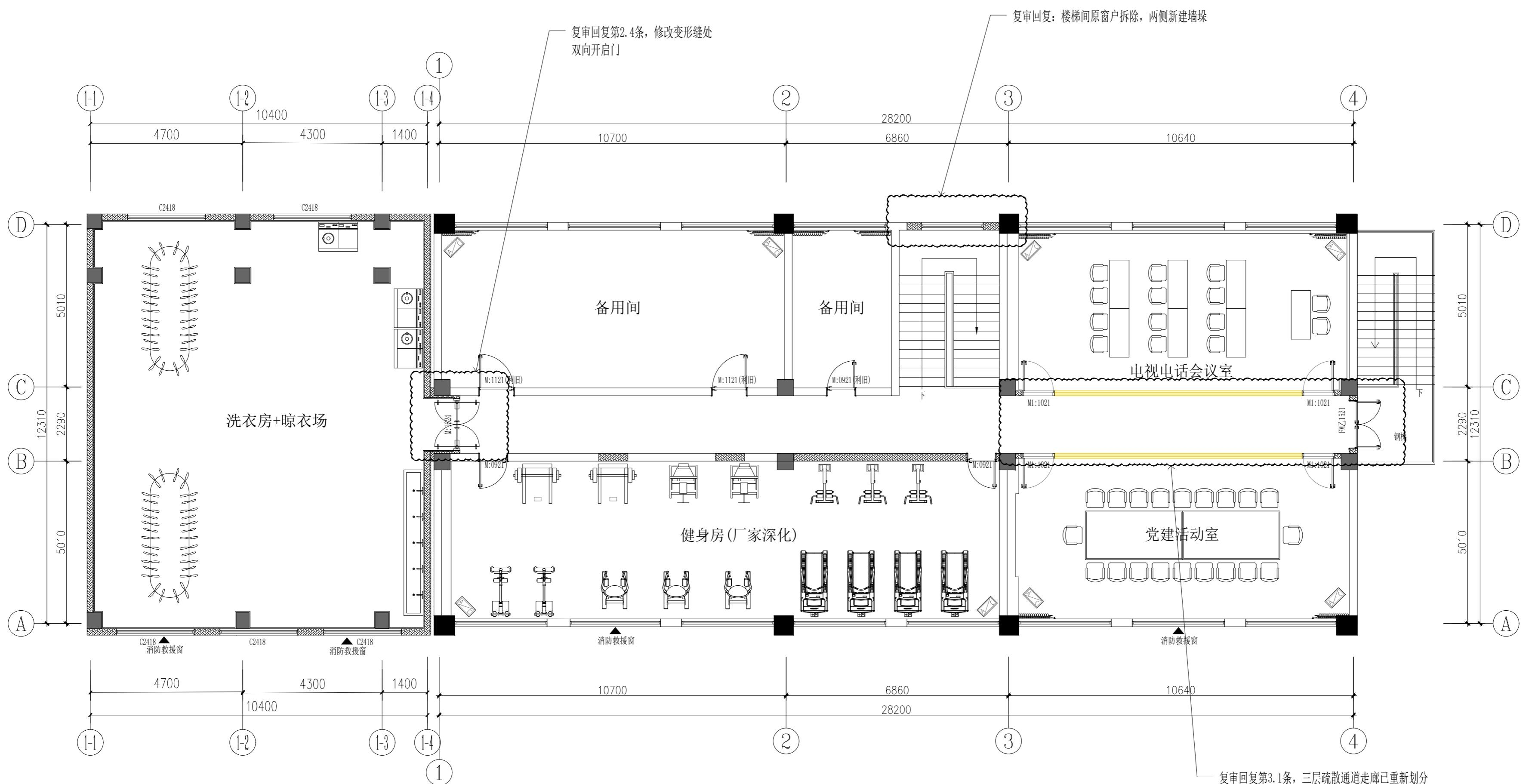
注: 备勤室等房间开向公共走廊或封闭式外走廊的疏散门, 应在关闭后具有烟闭的性能
