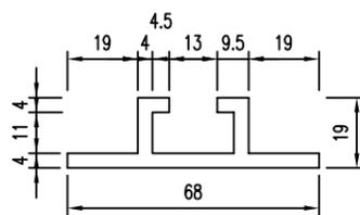
支柱法兰平面图
