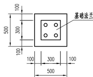
加筋法兰平面图
