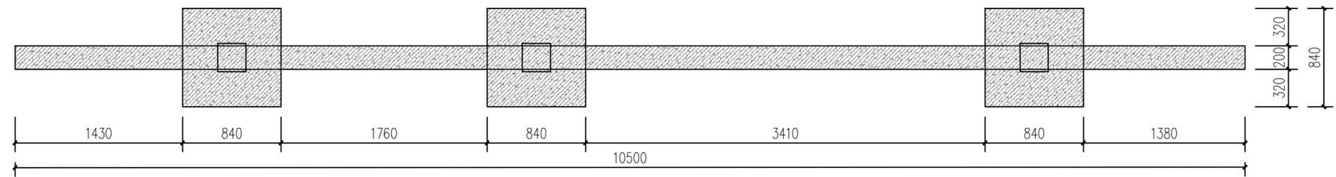
② 格栅景墙基础平面图 1:30
