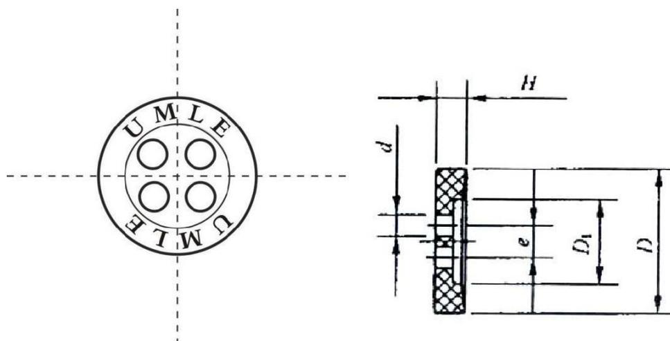
图 70 II 类纽扣外观式样和结构尺寸
