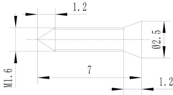
图 59b 螺钉结构及主要尺寸
