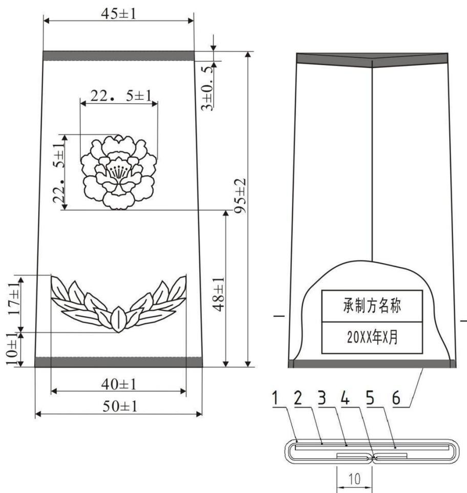
1—丝织版面;2—机织热熔粘合衬布;3—热熔胶片;4—缝纫线;5—树脂衬;6—锁边线
