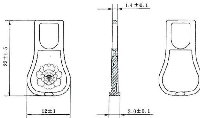
图 80 5 号注塑拉链的拉片样式
