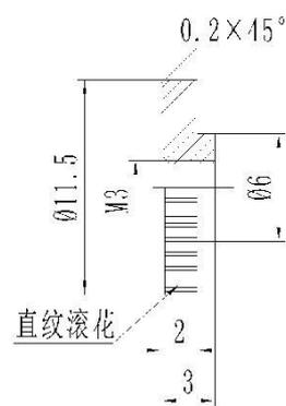
图 53b 螺钉结构及主要尺寸
