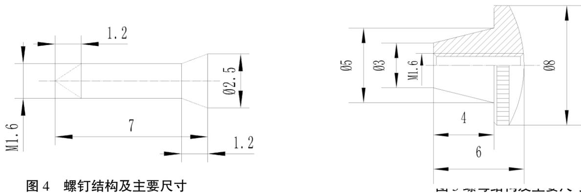
图 4 螺钉结构及主要尺寸
