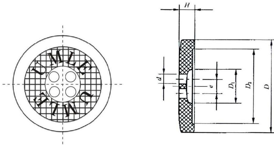
图 69 I 类纽扣外观式样和结构尺寸
