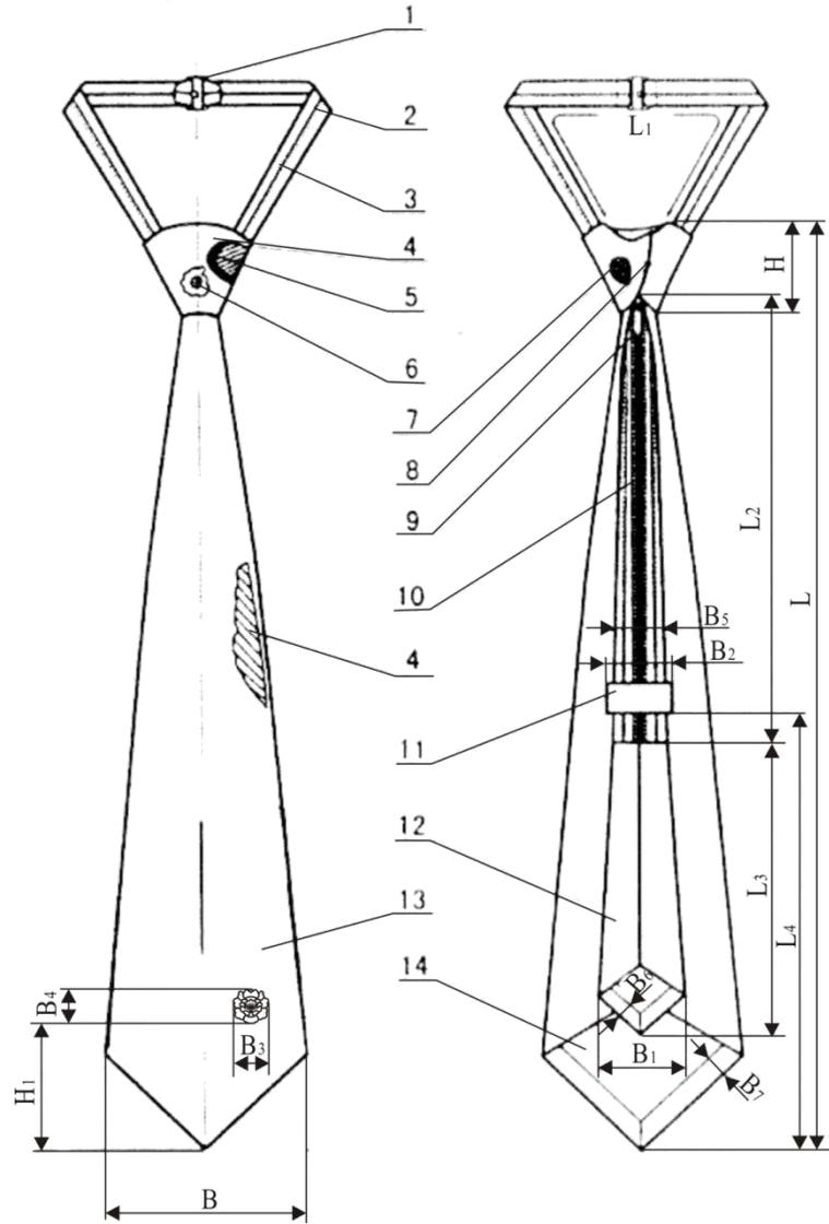
1-保险扣;2-颈带;3-缝纫线;4-起绒羊毛衬布;5-垫片;6-铆钉;7-骨架
