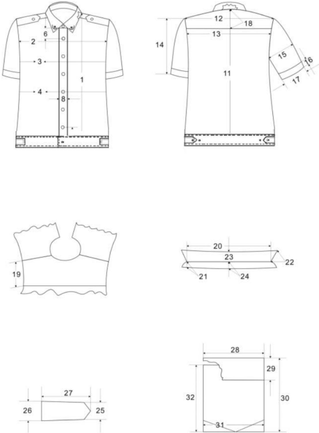
图 22 男短袖制式衬衣规格测量图
