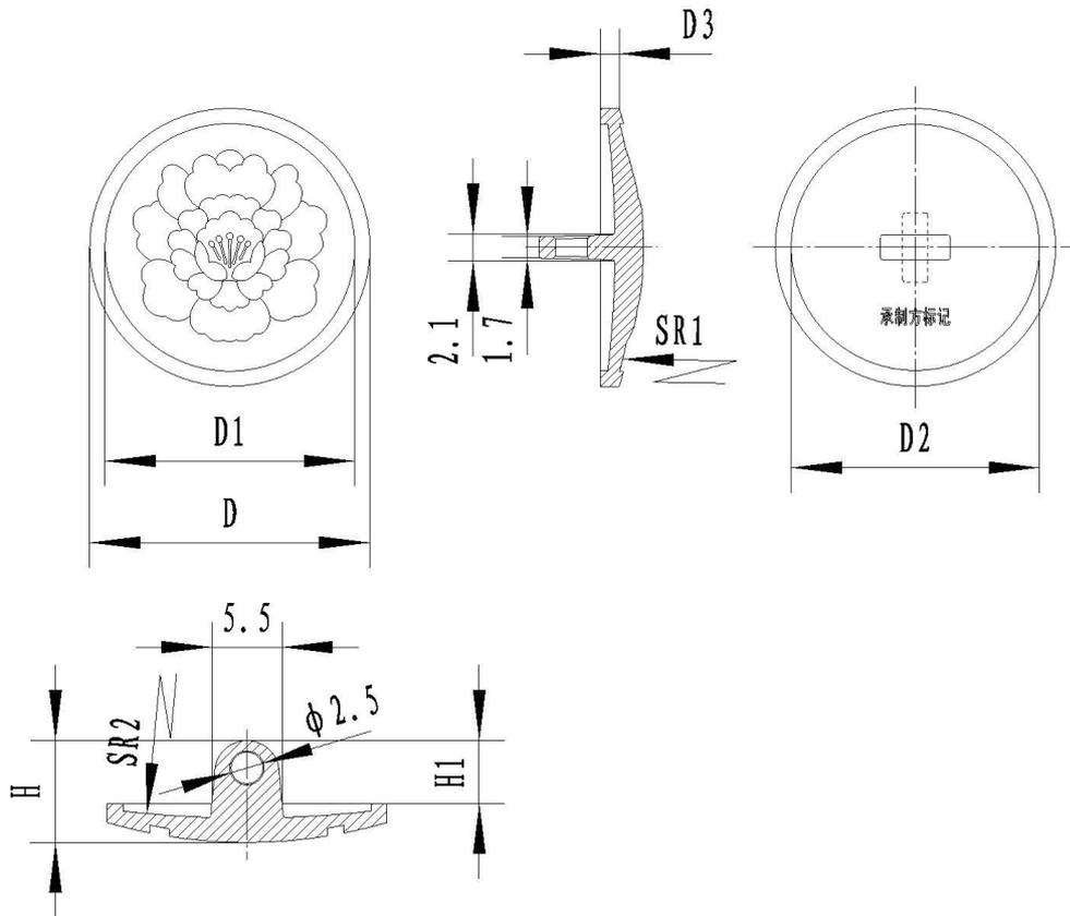
图 68 金属扣结构和主要尺寸
