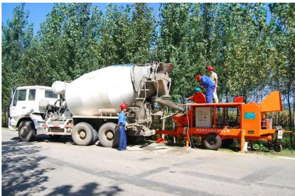
图 3.3-2 混凝土泵车
