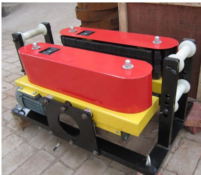
图 4.3-1 电缆输送机
