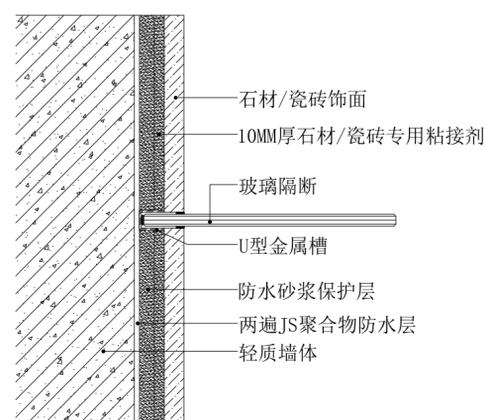
卫生间玻璃隔断墙面收口节点图
