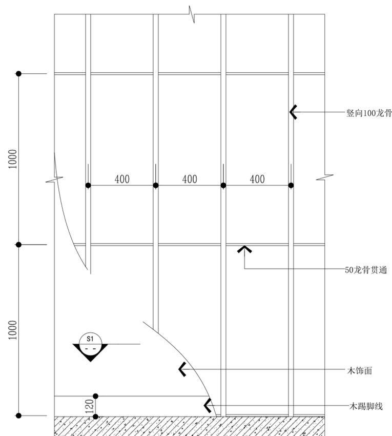
适用范围: 该节点适用于墙面造型出墙距离超过300mm的轻钢龙骨基层的制作。
