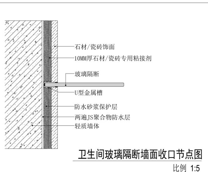
卫生间玻璃隔断墙面收口节点图
