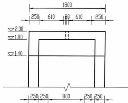
启闭机梁及排架结构图 1:50
