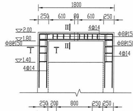
启闭机梁及排架配筋图 1:50
