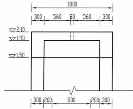
启闭机梁及排架结构图 1:50
