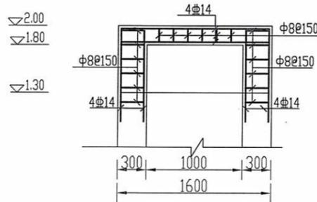
启闭机梁及排架配筋图 1:50
