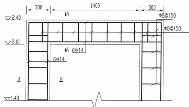
启闭机梁及排架配筋图 1:25
