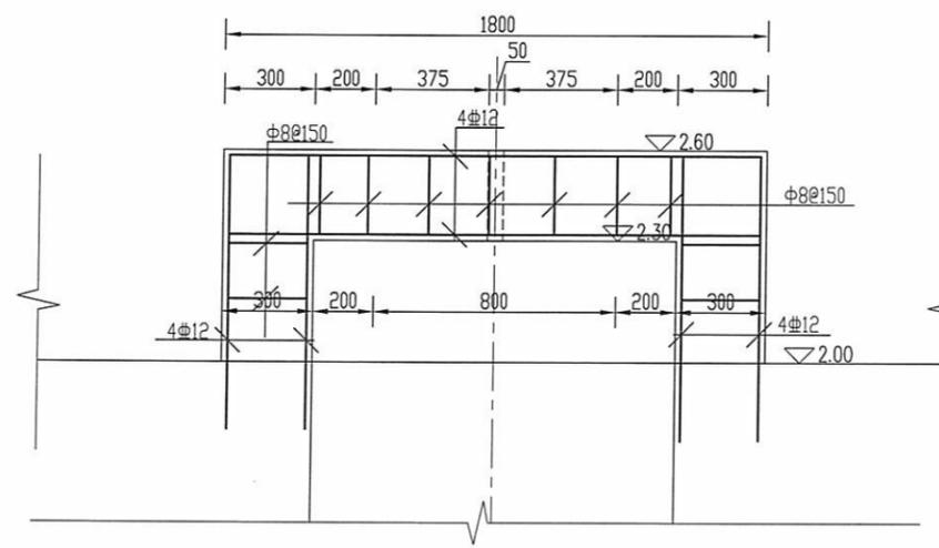
DN800 闸门启闭机梁及排架配筋图 1:25
