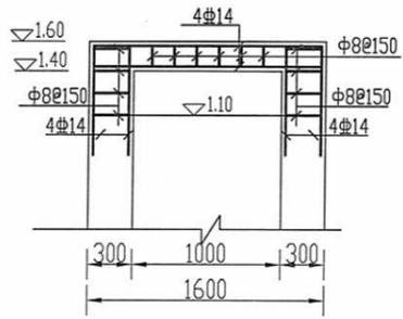
启闭机梁及排架配筋图 1:50
