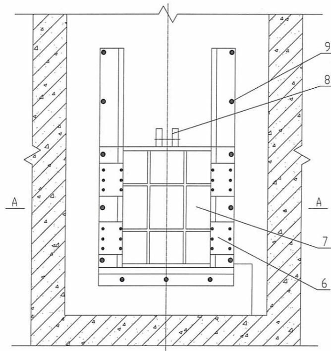
6-楔紧装置;7-门板;8-吊耳;9-地脚螺栓孔
