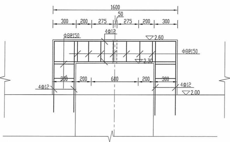
DN600 闸门启闭机梁及排架配筋图 1:25
