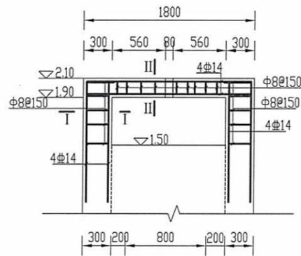
启闭机梁及排架配筋图 1:50
