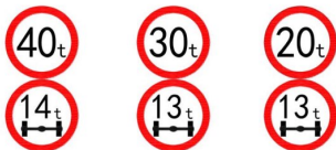
本项目桥梁限载标志版面
