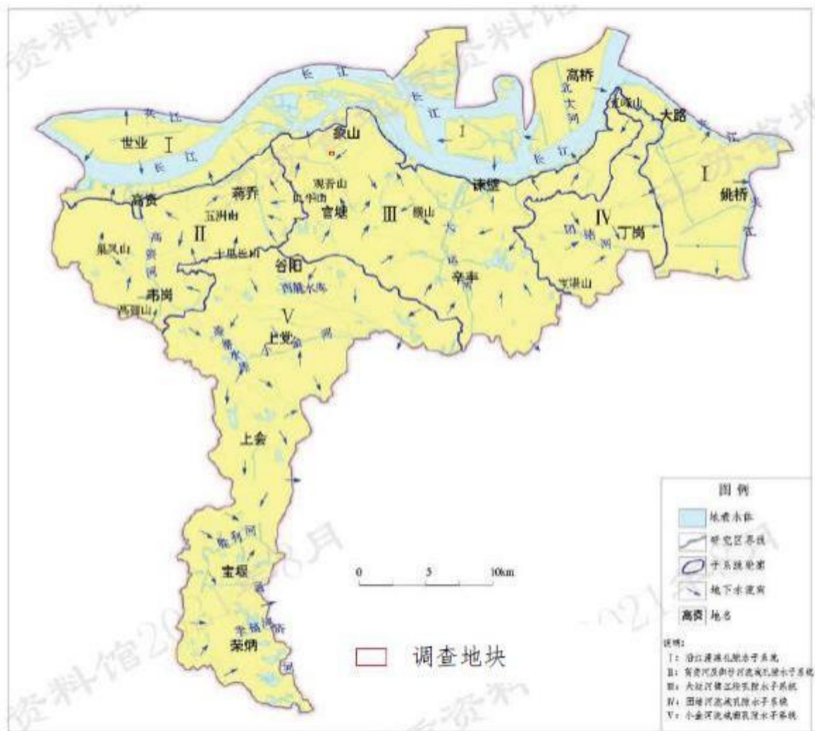
图2.1-5 镇江地区第四系孔隙水系统分区图
